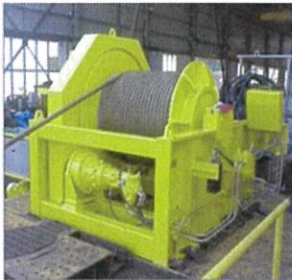
Riser Tensioner Winch
